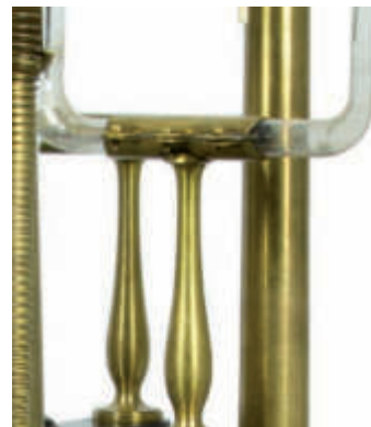
Particolare del secondo apparato per i movimenti verticali. L'oscillazione della molla mette in contatto il pesetto conico con il mercurio della vaschetta sottostante, chiudendo il circuito elettrico sul registratore.
