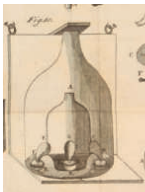
Sismoscopio a mercurio Cavalli: disegno allegato alla descrizione che Cavalli diede della prima formulazione dello strumento, poi perfezionato con la registrazione oraria.
