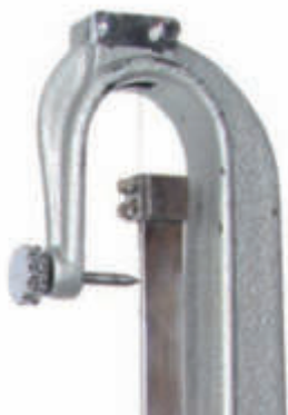
Fotosismografo orizzontale: attacco della sospensione dell'asse verticale di oscillazione del pendolo e del sistema di modifica del periodo proprio di oscillazione.
