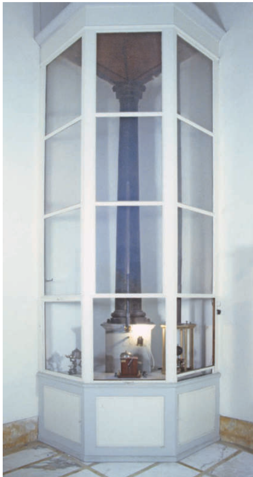
Pilastro sismico dell'Osservatorio del Collegio alla Querce di Firenze dopo i restauri dei primi anni '90 del Novecento. Al centro vi è la colonna di ghisa degli strumenti pendolari: tromometro (centro), isosismometro (sinistra) e ortosismometro (destra). In primo piano vi è un ricevitore telegrafico Breguet, trafugato a fine Novecento.
