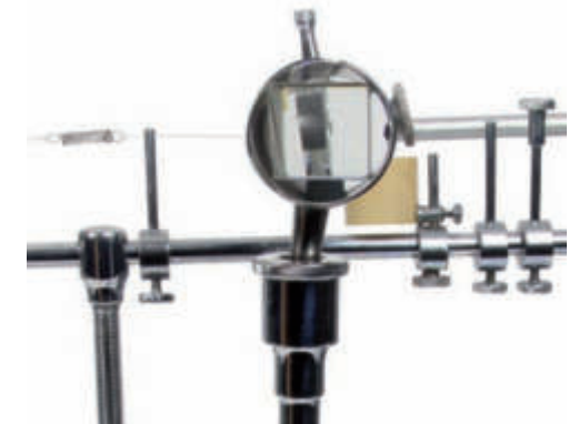
Fotosismografo verticale: particolare del sistema a prisma per la rotazione di 90° del raggio riflesso dallo specchietto messo in moto dal sismometro.
