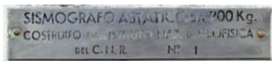
Targa del primo sismografo astatico Wiechert da 200 kg realizzato nelle officine dell'ING.
