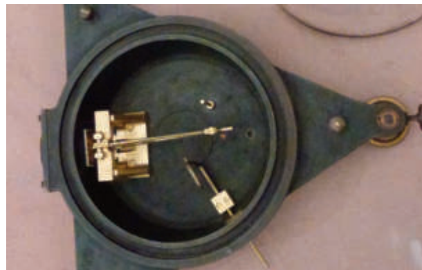
Sismografo installato da Rebeur-Paschwitz a Wilhelmshaven. Lo strumento, parzialmente integrato di parti perdute, è oggi conservato al Museo di sismologia e geomagnetismo dell'Università di Strasburgo.
