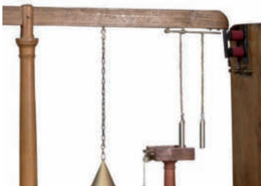
Fotocronografo Càncani, primo modello: particolare del sistema di sblocco del dispositivo di attivazione dello scatto della fotografia dell'orologio.
