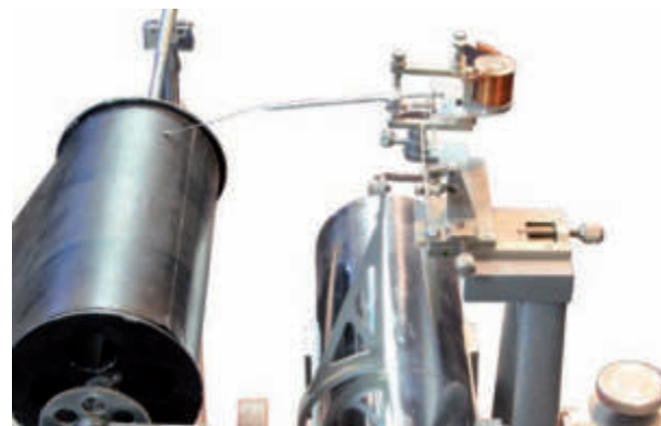
Vista laterale del meccanismo di registrazione a carta affumicata di uno degli esemplari di accelerometro Ishimoto orizzontale realizzati dall'ING. Lo strumento è esposto al Museo Geofisico di Rocca di Papa.
