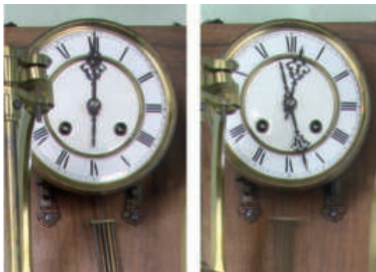
Particolare dell'orologio per rilevare l'orario di avvio della registrazione. A sinistra l'orologio è in posizione di riposo sul mezzogiorno, a destra dopo l'avvio.
