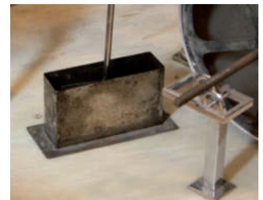
Particolare della vaschetta dell'olio dello smorzatore di una delle componenti dello strumento.
