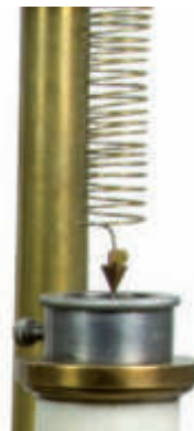
Particolare del secondo apparato per i movimenti verticali. L'oscillazione della molla mette in contatto il pesetto conico con il mercurio della vaschetta sottostante, chiudendo il circuito elettrico sul registratore.
