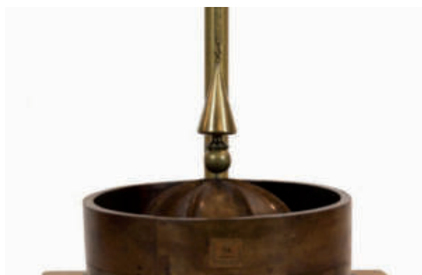
Parte terminale del pendolo in posizione di riposo. La massa pendolare conica con il suo peso mantiene in delicato equilibrio la sfera che poggia sulla punta metallica della calotta sferica della base di legno.
