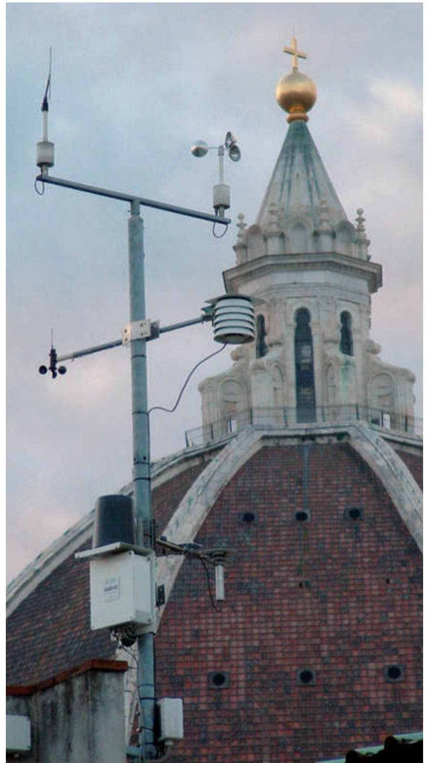
Stazione meteorologica digitale su una terrazza dell'Osservatorio Ximeniano. Sullo sfondo la cupola di Brunelleschi della cattedrale di Santa Maria del Fiore.
