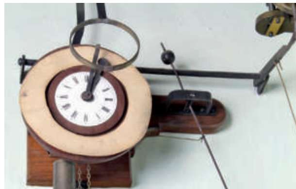
Particolare del sistema per segnare l'orario delle scosse. All'avvio della registrazione un anello di ottone urta le lancette, le cui matite segnano sulla carta due punti da cui si risale all'orario.
