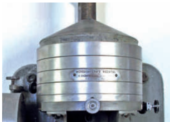
Microsismografo Vicentini dell'Osservatorio di Pesaro: particolare del pendolo per le componenti orizzontali, con il contenitore della massa e dell'olio di smorzamento.
