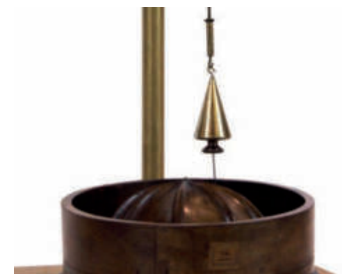
Parte terminale del pendolo dopo l'attivazione. La sfera è caduta e ha chiuso il circuito elettrico, mentre l'ago uscendo indica la direzione del moto sismico.
