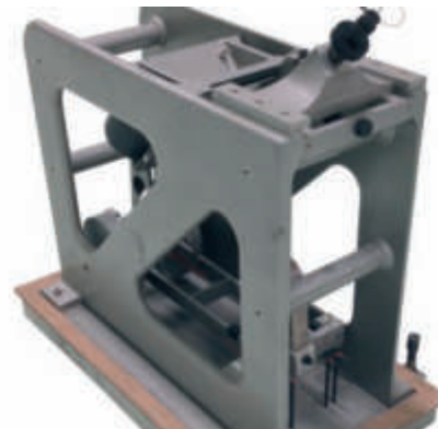
Sismometro Sprengnether per la componente verticale. Il magnete di sinistra serve per la rilevazione e l'amplificazione del moto sismico, mentre quello di destra per lo smorzamento.
