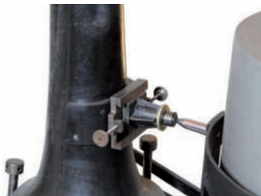
Particolare della punta inferiore di rotazione del pendolo orizzontale. La posizione del punto di rotazione è regolabile orizzontalmente.
