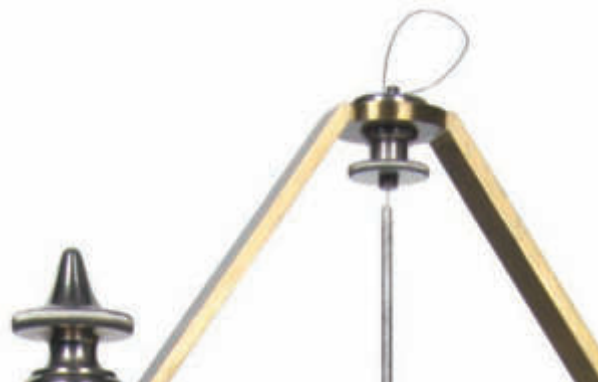
Sospensione del pendolo superiore dell'avvisatore Bertelli. Un sottile filo d'acciaio, solidale con l'asta rigida del pendolo superiore, è fissato con un sistema che ne consente la regolazione verticale.
