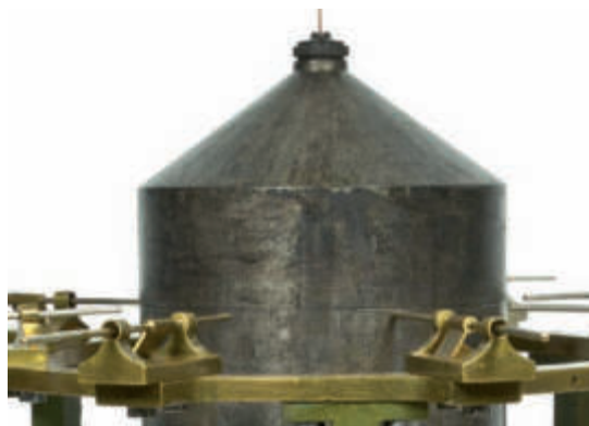
Isosismometro Bertelli: particolare della massa e della corona di asticelle per la misura e l'orientamento delle oscillazioni del pendolo.
