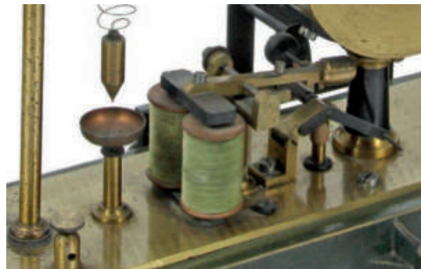
Particolare della massa del sensore verticale e dell'elettrocalamita responsabile dello sblocco del pendolo dell'orologio in caso di terremoto.
