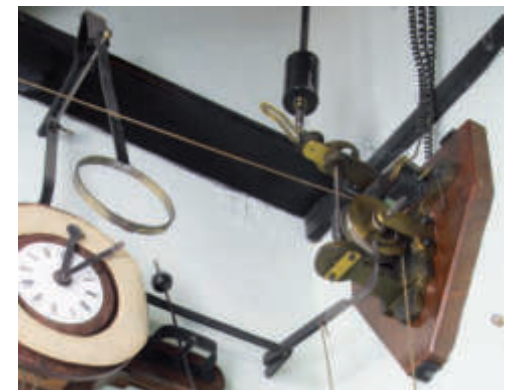
Particolare del sistema di controllo dell'avvio e della velocità di scorrimento delle carte di registrazione.
