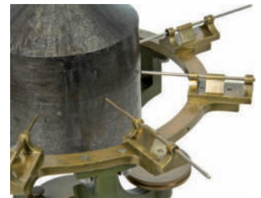
Particolare visto dall'alto della massa e della corona di asticelle per la misura e l'orientamento delle oscillazioni del pendolo.
