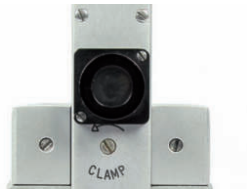
Sismometro Wood-Anderson: vista frontale con la lente in corrispondenza dello specchio per la registrazione e a destra e sinistra le espansioni polari del magnete di smorzamento.
