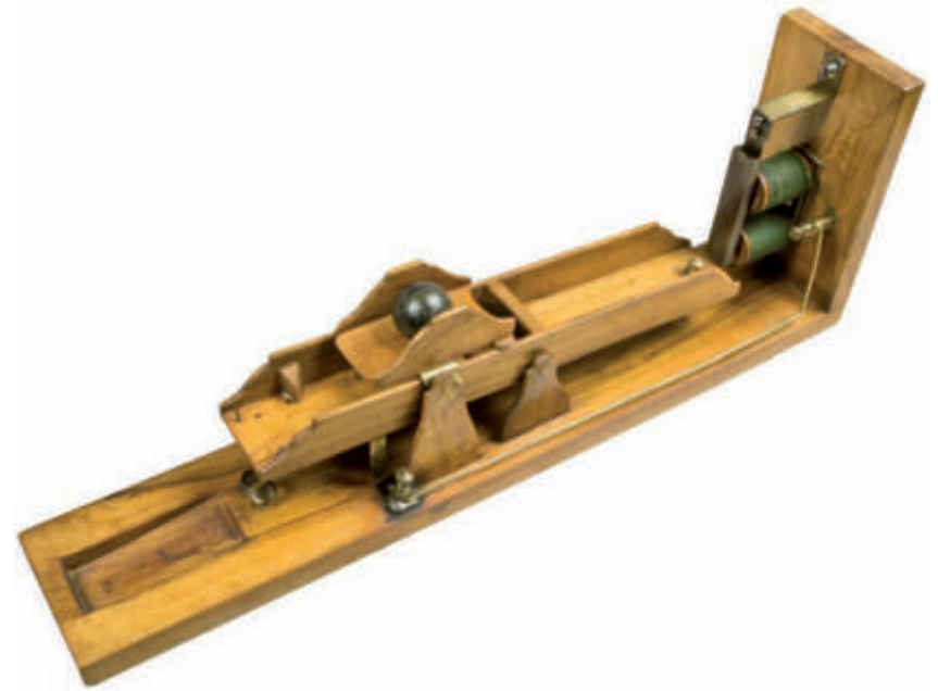
Bascula a canale del secondo modello di fotocronografo Cànani, che costituisce il sistema di accensione della lampada all'interno della camera oscura contenente il cronometro di precisione per fissare l'ora di inizio della registrazione di un terremoto.
