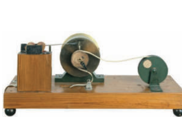
Vista posteriore del registratore Guzzanti: in primo piano la ruota di legno per il trascinamento della carta, di tipo telegrafico, mantenuto in rotazione dal meccanismo dell'orologio e su cui scrive un pennino inchiostro.
