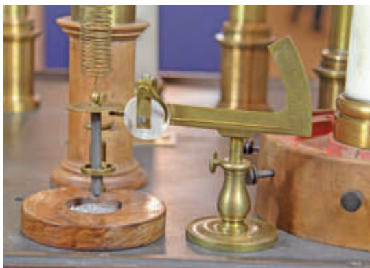
Sensore del sismografo elettromagnetico Palmieri: particolare dell'apparato per i moti verticali e per la misura della
