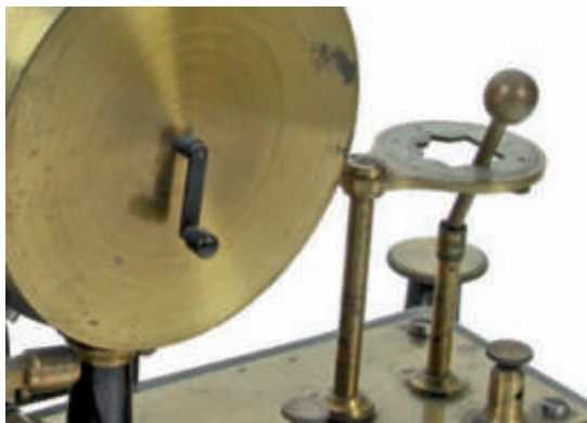
Avvisatore Galli-Brassart per le scosse ondulatorie e sussultorie : retro dell'orologio e sensore per i movimenti orizzontali. La leva sul retro dell'orologio permette di sollevare il pendolo per bloccarlo.
