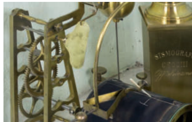
Particolare del blocco dell'orologeria dei rulli di registrazione. L'aletta di ottone è tenuta ferma da una forcilla legata al filo del peso dell'avvisatore. La caduta del peso solleva la forcilla e sblocca la registrazione.
