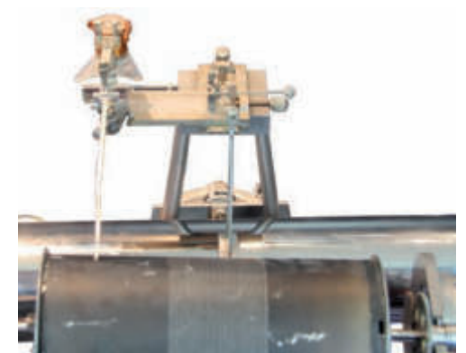
Vista frontale del meccanismo di registrazione a carta affumicata di uno degli esemplari di accelerometro Ishimoto orizzontale realizzati dall'ING.
