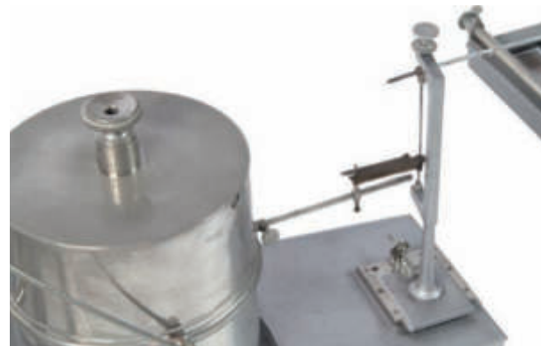
Trepidometro orizzontale Alfani: particolare della massa e del meccanismo di trasmissione del movimento al pennino di registrazione.
