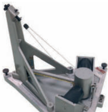
Sismometro Sprengnether per la componente orizzontale. Il magnete di sinistra serve per la rilevazione e l'amplificazione del moto sismico, mentre quello di destra per lo smorzamento.
