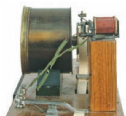
Vista laterale: in primo piano una delle due bobine dell'elettrocalamita di registrazione. In secondo piano la rotella di scorrimento della carta.
