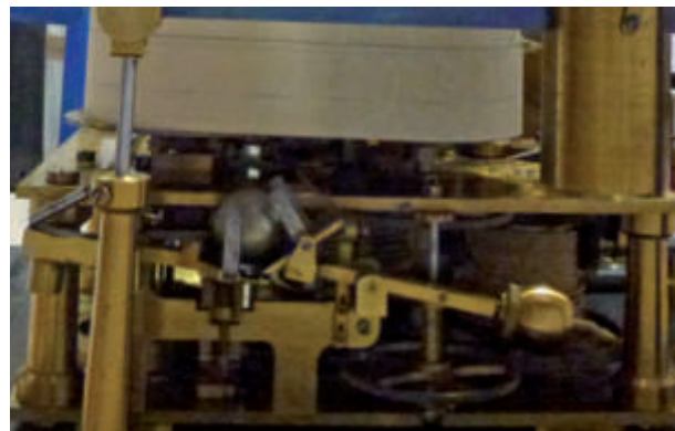
Meccanismo di attivazione del controllo delle due velocità di rotazione del tamburo di registrazione. In primo piano la sfera che, cadendo all'occorrenza di un terremoto, attiva la velocità più alta di registrazione.
