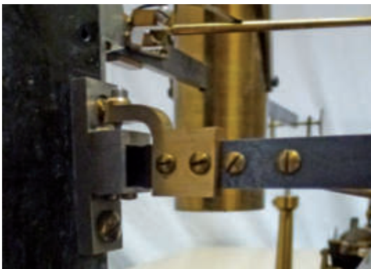
Particolare del punto di rotazione del braccio di un pendolo conico. Il terminale del braccio, a forma di coltello, ruota in una scanalatura la cui forma a V riduce al minimo l'attrito.
