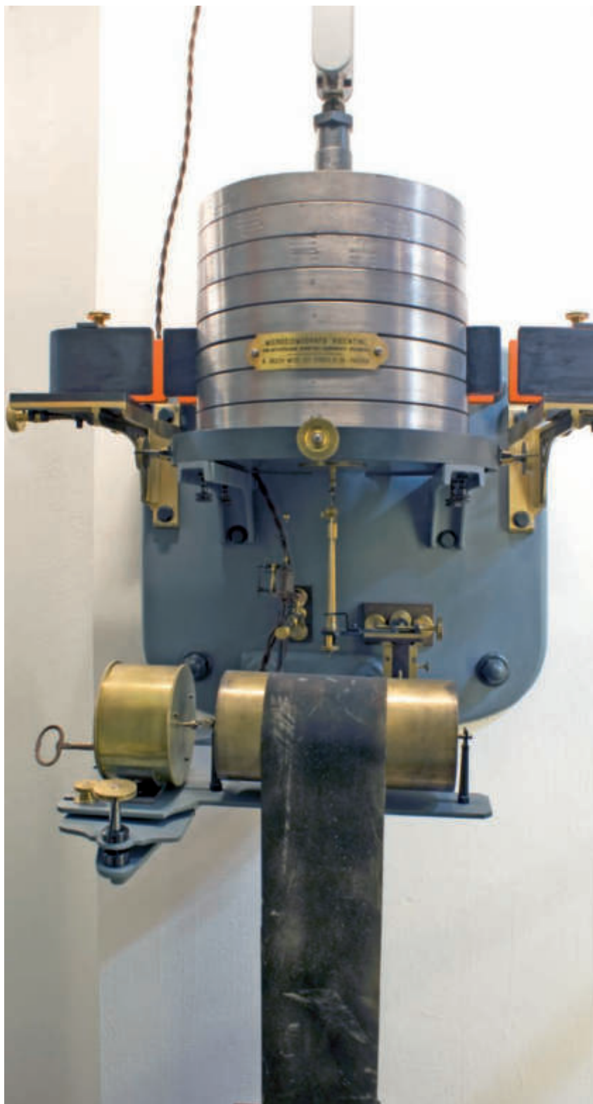
Microsismografo Vicentini per la componente orizzontale N-S dell'Osservatorio del Collegio Alberoni di Piacenza: particolare della massa, con il sistema di astatizzazione magnetica, e del sistema di registrazione
