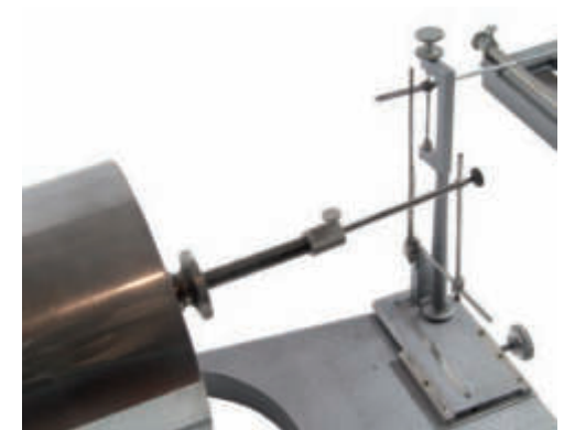
Trepidometro verticale Alfani: particolare della massa e del meccanismo di trasformazione del suo movimento verticale in un movimento orizzontale del pennino.
