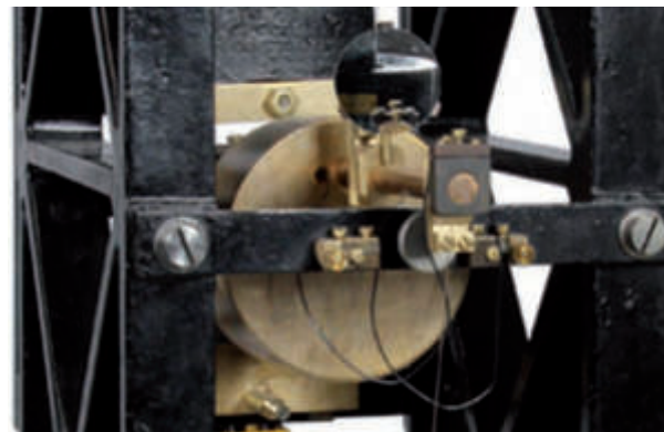
Sismografo orizzontale Galitzin: particolare della sospensione della massa pendolare e dello specchio di taratura. I fili in primo piano provengono dalle bobine poste sul lato opposto e sono collegati al galvanometro.
