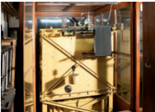
Microsismografo astatico verticale Wiechert da 1.300 kg di Göttingen: vista frontale con il meccanismo di registrazione.
