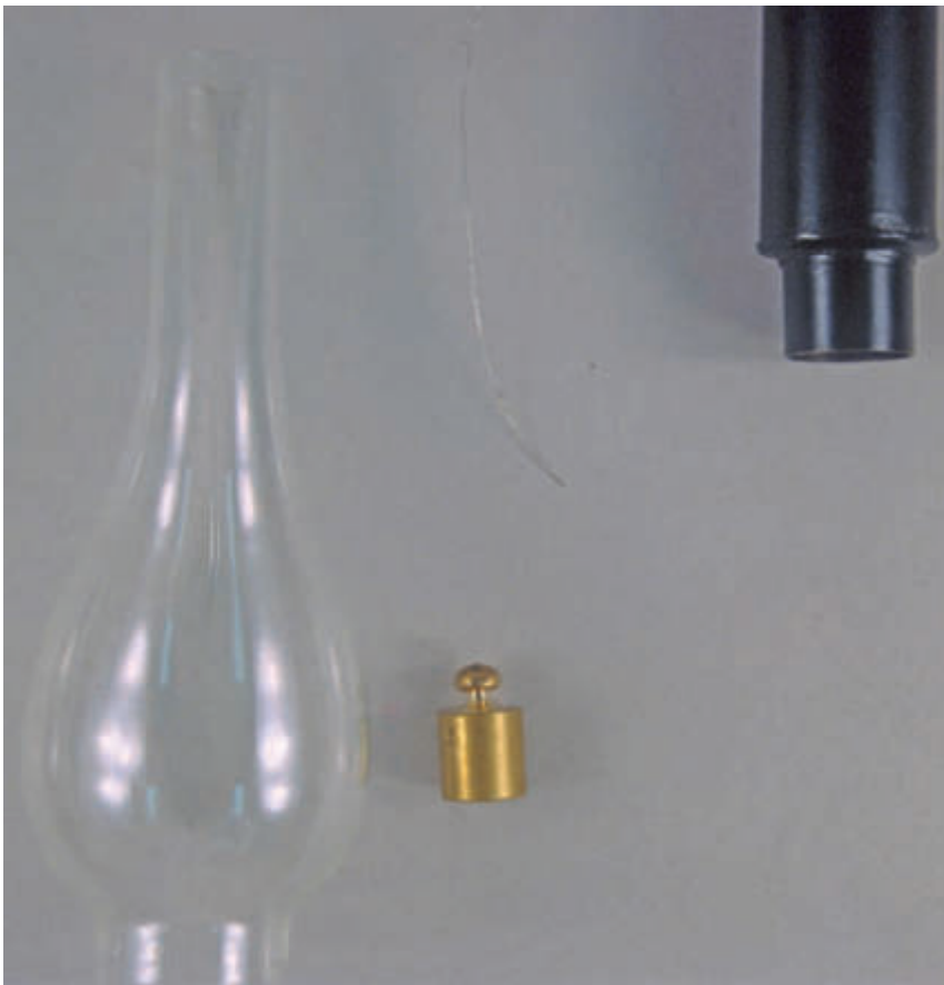
13) Principali componenti di un tromometro. Un peso da bilancia da 100 g, un filo di rame, un tubo di lamiera e uno di vetro di protezione. A questi andava aggiunto un cannocchiale da microscopio, dotato di scala graduata.
