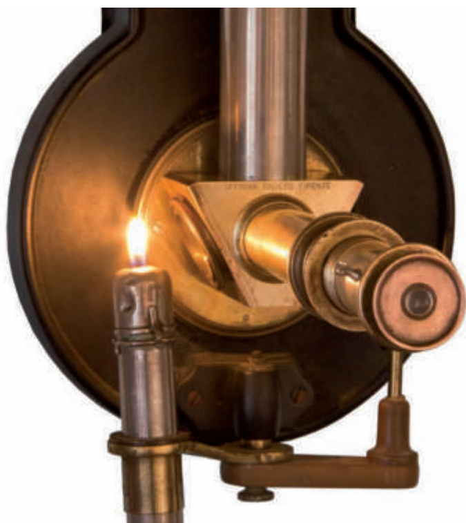
Uno dei tromometri a prisma realizzati dall'Officina Galileo di Firenze, fra il 1875 e il 1880 circa. Questo esemplare è appartenuto a G. Alfani che lo utilizzò fin dal 1895, prima al Seminario Gavi di Livorno, poi all'Osservatorio Ximeniano di Firenze, dal 1905. Un altro esemplare di questo tromometro fu donato al papa Leone XIII per il suo giubileo sacerdotale nel 1888.
