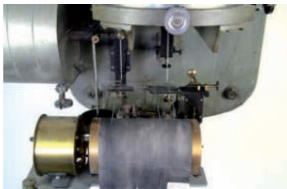
Particolare del sistema di registrazione; da sinistra i pennini delle componenti verticale e orizzontali.
