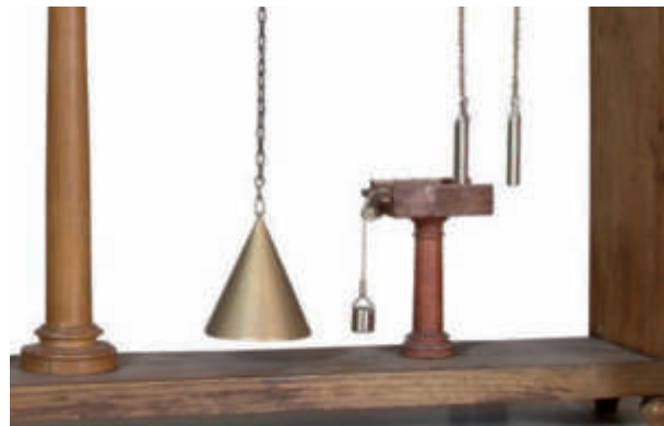
Fotocronografo Càncani, primo modello: particolare dei pesi responsabili dell'attivazione dello scatto della fotografia dell'orologio.
