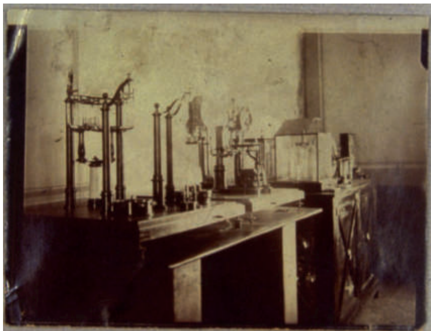
7) Sismografo elettromagnetico Palmieri in una fotografia storica della fine del XIX secolo.
