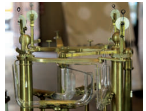
Sistema di tubi a U per i movimenti orizzontali. L'oscillazione del mercurio nei tubi, assente nella foto, chiude un circuito elettrico che attiva la registrazione.
