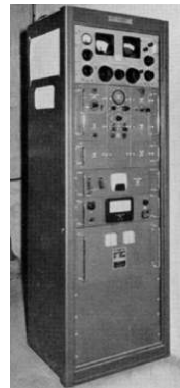
Pannello dei comandi e dei controlli della stazione WWSSN dell'Aquila, in una fotografia dei primi anni sessanta del Novecento.
