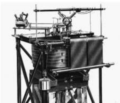
Microsismografo Wiechert da 1.000 kg: la massa, gli smorzatori e il meccanismo di registrazione in un disegno del catalogo della Spindler & Hoyer.
