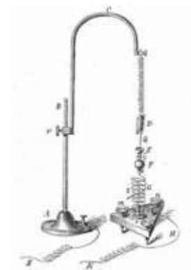
Versione dell'avvisatore Bertelli con i pendoli a molla invece che rigidi. L'immagine è tratta dall'unica descrizione nota dello strumento da parte dell'autore.
