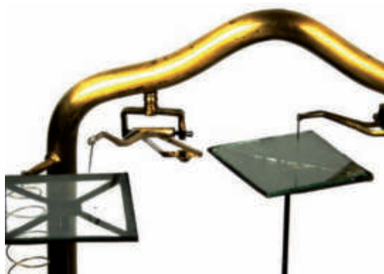
Particolare degli apparati di registrazione su vetro affumicato dei movimenti orizzontali. I pennini sono solidali con la struttura del sismografo mentre si muovono i vetri di registrazione.
