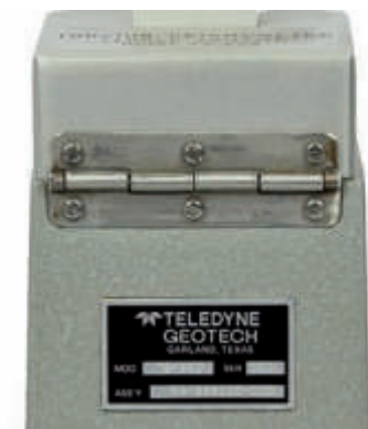
Vista posteriore con la cerniera per l'inserimento o disinserimento del magnete di smorzamento.
