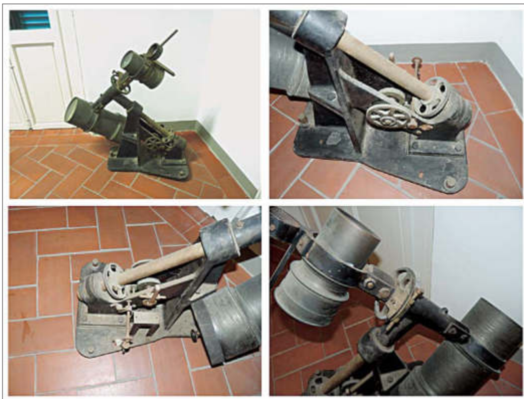
Fig. 2 – Alcune immagini che mostrano lo “stato di conservazione” dell’equatoriale. Nella prima figura a sinistra si nota che gli obbiettivi erano stati rovesciati rispetto alla loro posizione corretta. Le altre mostrano i meccanismi e il loro stato di ossidazione.
