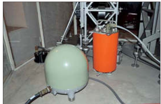
Fig. 3 – Sensori sul pilastro di cemento. Il sensore verde grande è il velocimetro Trillium 240. Il sensore nero piccolo è l'accelerometro Episensor; il sensore arancione è un S13 per la componente verticale ed è quello della stazione sismica in funzione precedentemente.
