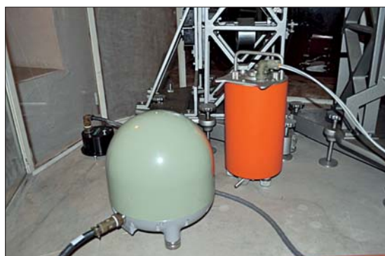
Fig. 3 – Sensori sul pilastro di cemento. Il sensore verde grande è il velocimetro Trillium 240. Il sensore nero piccolo è l'accelerometro Episensor; il sensore arancione è un S13 per la componente verticale ed è quello della stazione sismica in funzione precedentemente.
