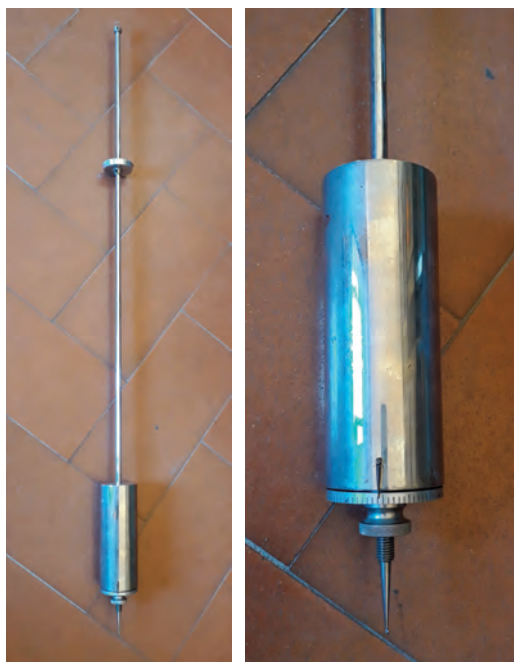
Fig. 1. Asta del pendolo (a sinistra), da notare la massa oscillante (vista nel particolare a destra) costituita da un recipiente contenente mercurio e con posizione su asta regolabile tramite vite micrometrica. In posizione intermedia il piattellino per il posizionamento di piccole masse aggiuntive di taratura.
