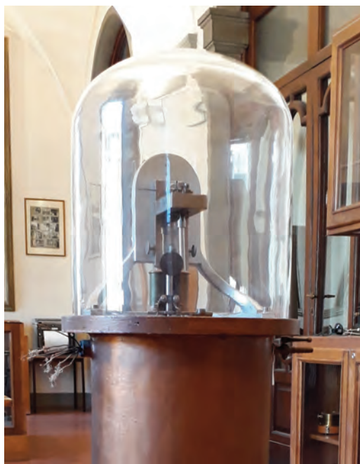
Fig. 2. Pendolo “Galileo” completo. Da notare il grosso contenitore di rame con rubinetto, sulla destra, per l’estrazione dell’aria. La campana di vetro poggia sul contenitore di rame attraverso una guarnizione in gomma per garantire l’ermeticità dell’insieme. I fili elettrici che fuoriescono alla sinistra del contenitore di rame servivano per l’alimentazione del sistema di scappamento elettromeccanico e per la sincronizzazione degli altri orologi dell’Istituto.
