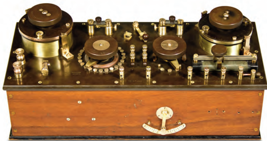
Fig. 13. Il ricevitore a cristalli Wireless Marconi, mod. P16 N° 5248, restaurato.
