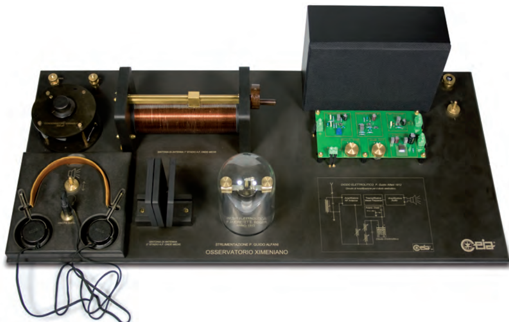
Fig. 4. Ricevitore a diodo elettrolitico Alfani ricostruito.
