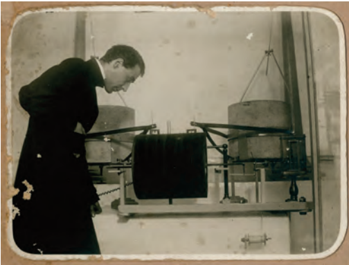
Fig. 9. Un giovane Alfani osserva le registrazioni del suo Tromometrografo Omori-Alfani. Questa foto storica si riferisce agli anni fra il 1905 e il 1910 circa.
