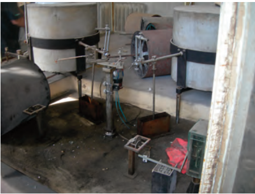
Fig. 10. Particolare delle masse pendolari e dell'apparato registratore dei Tromometrografi Omori-Alfani dell'Osservatorio Schiavazzi di Livorno, prima del restauro.
