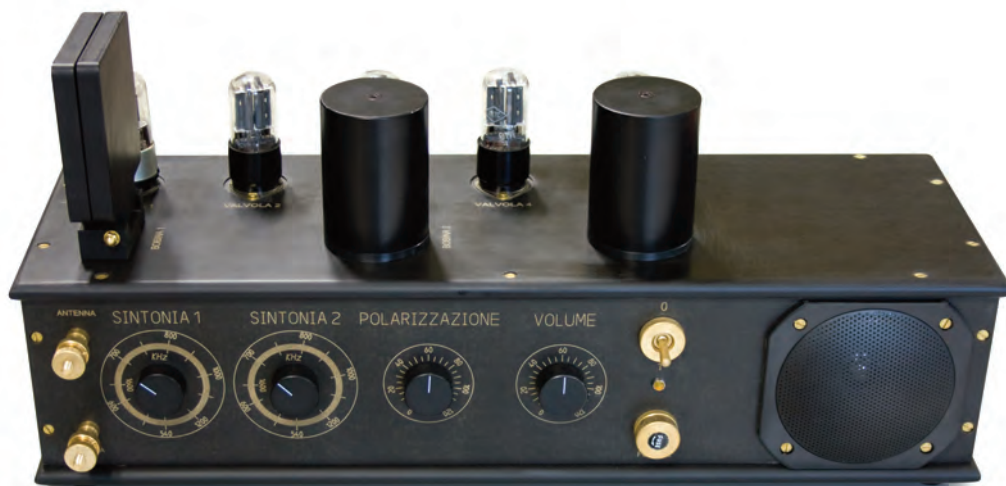
Fig. 10. Ricevitore omodina a cinque triodi restaurato.
