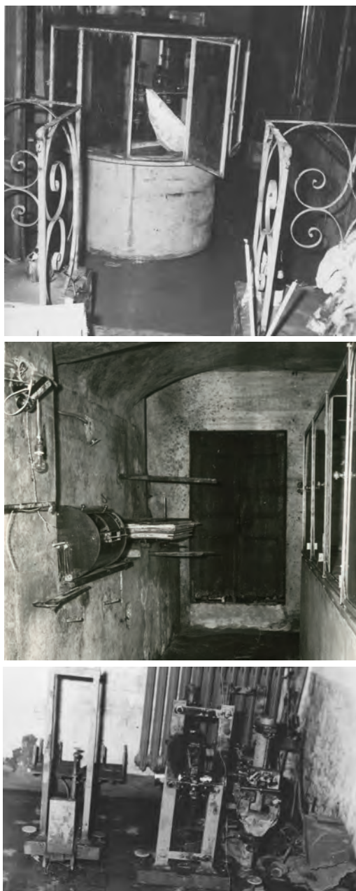
Fig. 15. Il Gabinetto sismologico sotterraneo Alfani devastato dalle acque e fango dell'Arno a seguito dell'alluvione del 4 novembre 1966. In alto il pilastro sismico, al centro la sala dei fotosismografi e in basso relitti di sismografi Galitzin - Alfani.
