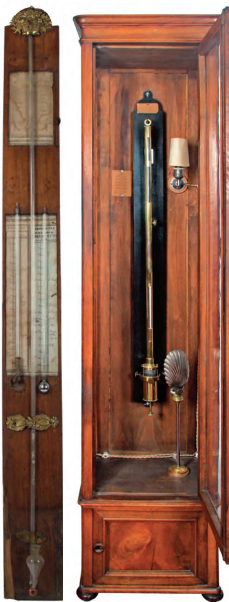
Fig. 3. sinistra: barometro di A. Pasquetti, la prima stazione meteorologica dell'Osservatorio (primi dell'800). Lo strumento comprende un barometro, un termometro e un igrometro.
