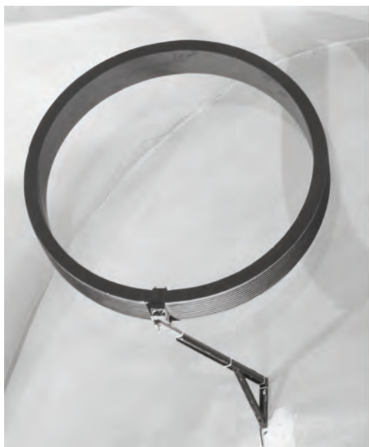
Fig. 16. Antenna a cilindro ( L=140 micro Henry), ricostruita, e antenna a telaio ( L=135,5 micro Henry) restaurata.
