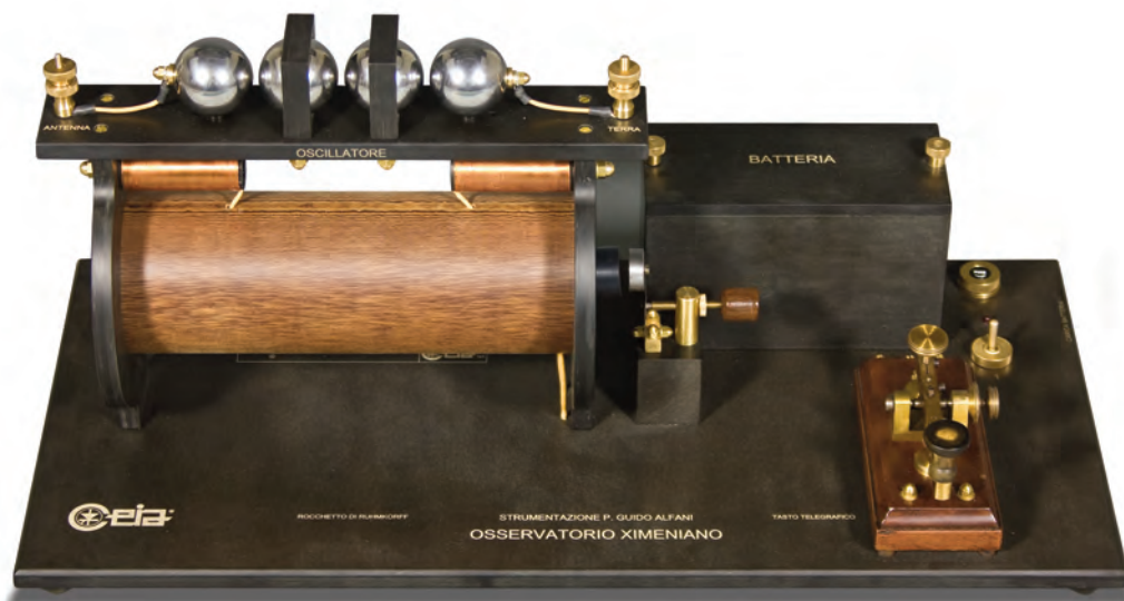
Fig. 8. Trasmettitore di Marconi del 1895 con rochetto di Ruhmkorff ricostruito.
