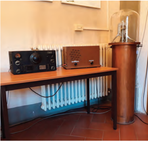
Fig. 5. Insieme completo di Ricevitore National HRO con alimentatore e interfaccia verso il pendolo “Galileo”. Da notare sul frontale dell’interfaccia a sinistra il commutatore che permetteva di passare rapidamente dall’ascolto in altoparlante al collegamento con l’orologio. L’operatore aspettava il momento della trasmissione del segnale orario e, pochi istanti prima dell’arrivo del segnale stesso, commutava l’uscita verso l’orologio a pendolo
