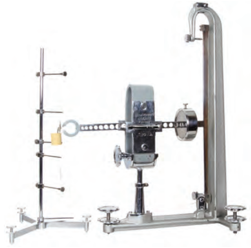
Fig. 17. Uno dei fotosismografi Alfani orizzontali restaurati dopo l'alluvione del 1966.
