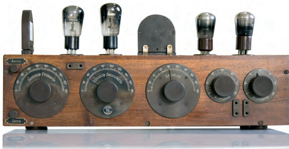
Fig. 15. Il radio ricevitore tipo SITI di Alfani, restaurato.
